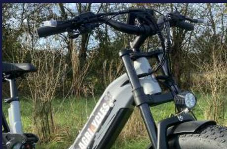
Le CR24 est équipé de composants de qualité, avec un moteur Bafang, une batterie LG 52V 20Ah haute capacité, ainsi qu'un système de transmission de vitesse Shimano. Il est idéal pour les utilisateurs mesurant de 165 à 190 cm, souhaitant une expérience de conduite sportive et dynamique. Le CR24 supporte une charge maximale de 150 kg.
