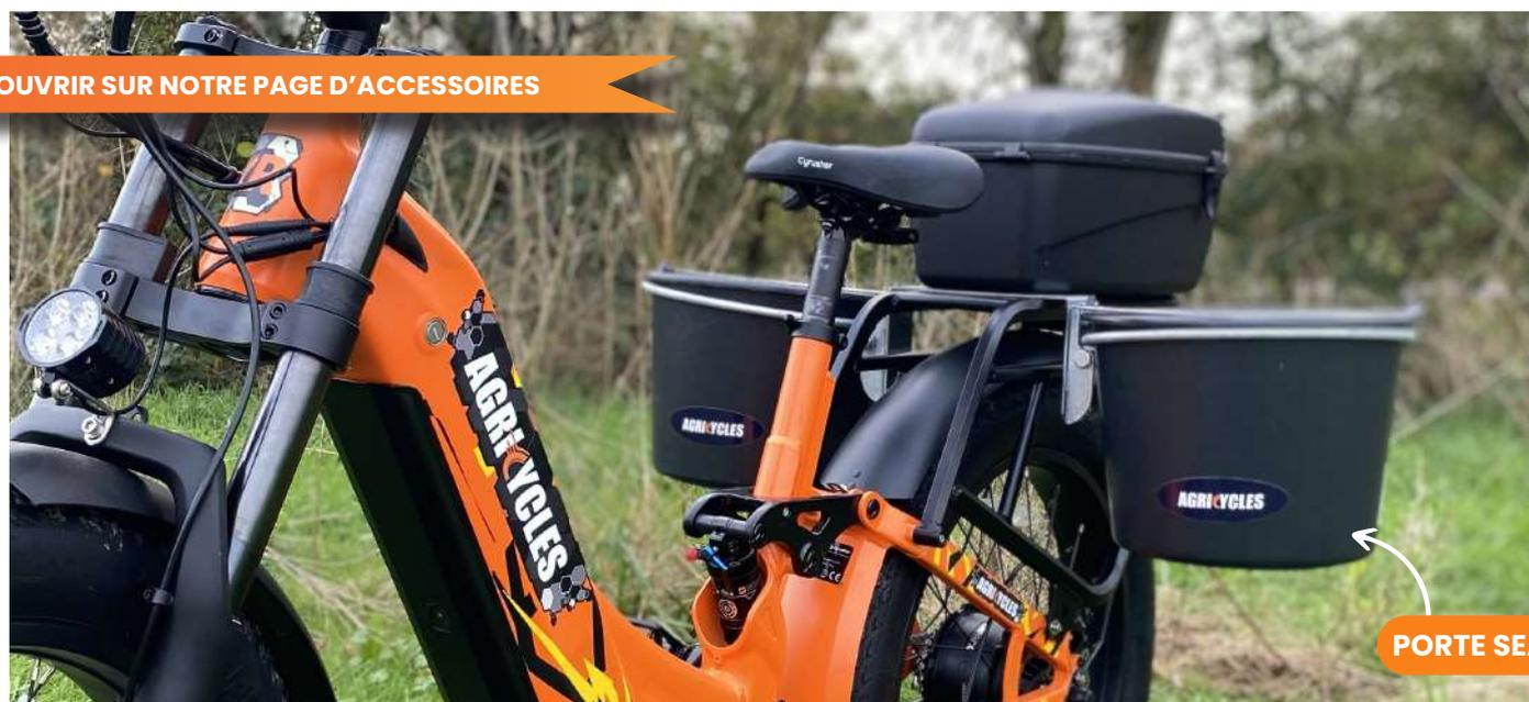
Motorisation 250W version homologuée voie publique, assistance jusqu'à 25 km/h. Motorisation 750W -> Version non homologuée réservée à un usage sur terrain privé hors voie publique, assistance jusqu'à 45 Km/h. Garantie : 2 ans pièces et batterie. Un kit d'outils de réglage et un numéro d'identification unique vous sont fournis.
