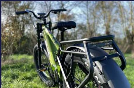
Le CR26 se distingue par ses caractéristiques techniques avancées, avec un moteur Bafang, une batterie LG 52V 20Ah haute capacité et un système de transmission de vitesse Shimano. Idéal pour les utilisateurs mesurant de 170 à 200 cm, le CR26 promet une expérience de conduite dynamique et fiable. Il peut supporter une charge maximale de 170 kg.
